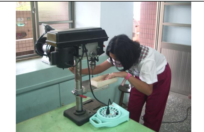
操作鑽孔機挖鑿強力磁鐵裝入位置
